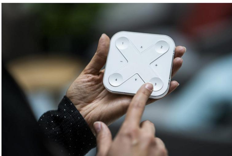
*Le contrôleur sans fil Xpress de Casambi peut être configuré pour contrôler les éclairages sans fil, en permettant la variation de l'intensité lumineuse vers le haut ou vers le bas, le changement de la température de couleur ou l'ajustement de l'équilibre entre l'éclairage direct et indirect*
